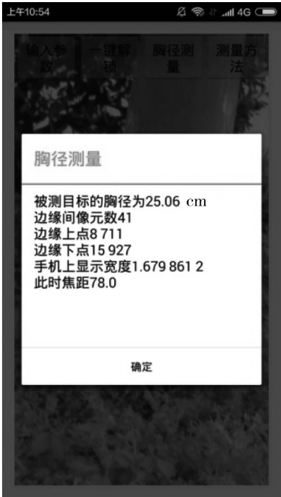
图 7 App 测量胸径结果示意图
